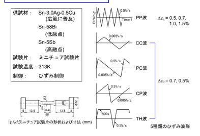
5種類のひずみ波形を用いて、各種はんだ(Sn-3.0Ag-0.5Cu、Sn-58Bi、Sn-5Sb)のミニチュア試験片による313Kでのクリープ疲労試験を実施しました。5種類のひずみ波形は、動作中の電子デバイスはんだ接合部のひずみの変化成分を模したものです。はんだミニチュア試験片は各材質のはんだ鋳塊から機械加工により上図に示す形状および寸法に製作しました。
