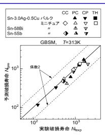
本研究では、はんだバルク試験片(標点部直径10mm程度の丸棒状試験片)で提案されている粒界すべり損傷モデル<sup>1)</sup>を、はんだミニチュア試験片のクリープ疲労寿命予測に適用しました。その結果、上図に示すように予測破損寿命が実験破損寿命にほぼ一致しました。
