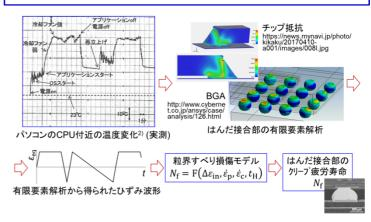
本研究により得られた実験結果を用いたはんだ接合部のクリープ疲労寿命評価の方法を上図に示します。この方法によりはんだ接合部のクリープ疲労寿命が精度良く評価できると考えられます。
