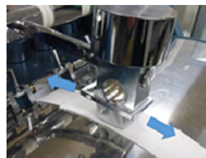
図3 摩擦堅牢度試験の様子
