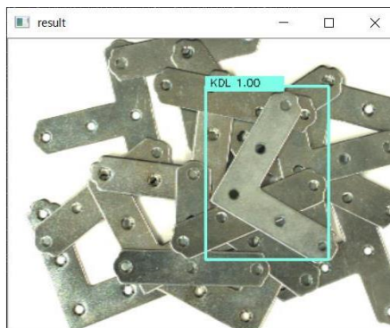
図2 L型金具の検出結果
