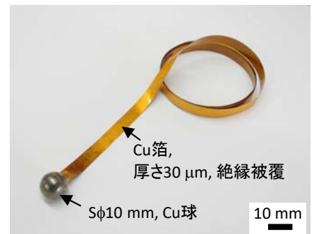
図2 長尺つり下げ電極の外観
