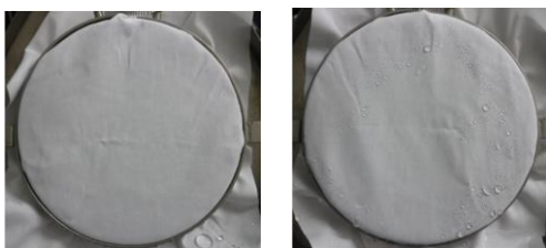
図4 はっ水度試験結果 （左:加工表面、右:裏面）
