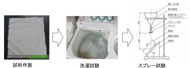
図3 撥水性の評価試験方法
