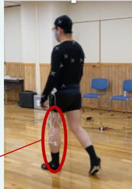
表面筋電センサを装着した歩行実験
