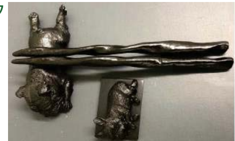
バイオプラスチック-セルロース複合体成形品
