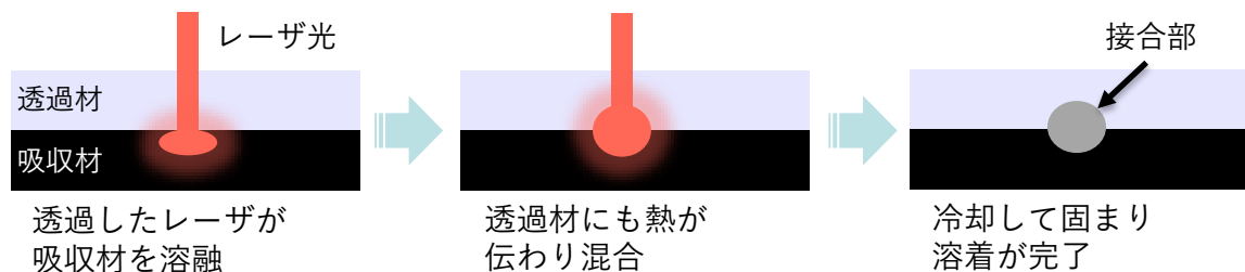
図1 レーザ溶着の流れ
