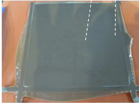
シート状ゴム成形品 CNFの配向性有 (CNF配合量: 5phr)
