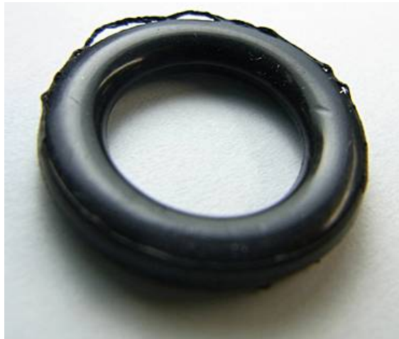
高圧による破壊
