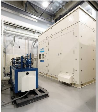
水素圧縮機(70+135MPa) ①インパルス・②気密・透過試験装置 ③水素暴露試験装置 ④低歪低速度引張装置
