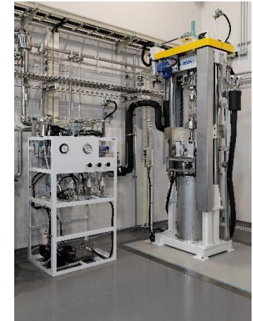
水素圧縮機(70+135MPa) ①インパルス・②気密・透過試験装置 ③水素暴露試験装置 ④低歪低速度引張装置
