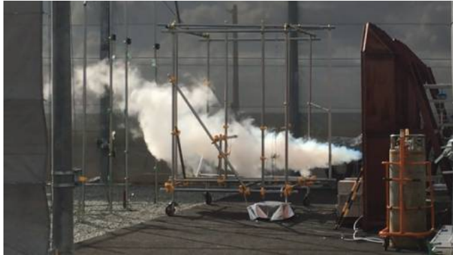
高压液化水素漏洩拡散試験の様子 (82MPa)
