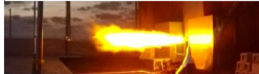
高压液化水素着火試験の様子 (82MPa)
