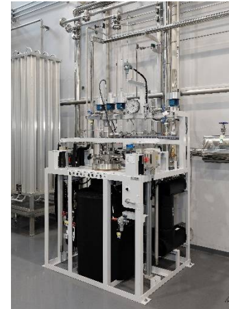
水素圧縮機(70+135MPa) ①インパルス・②気密・透過試験装置 ③水素暴露試験装置 ④低歪低速度引張装置
