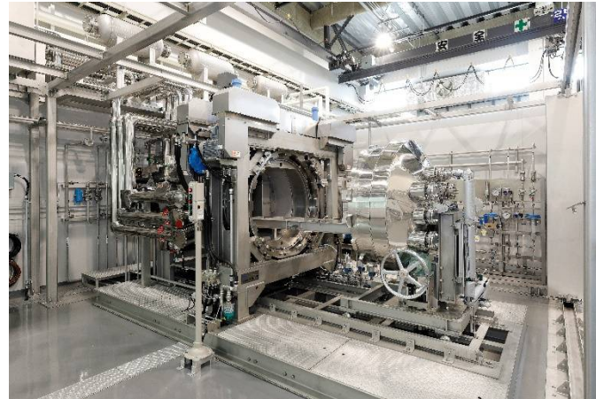
水素圧縮機(70+135MPa) ①インパルス・②気密・透過試験装置 ③水素暴露試験装置 ④低歪低速度引張装置
