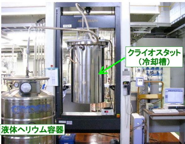
図 6 極低温材料試験装置
