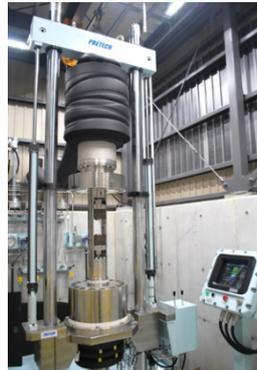
図1 高圧水素ガス材料試験装置
